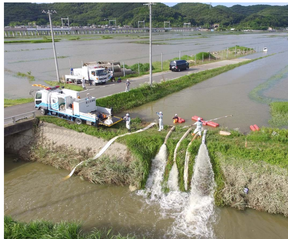
岡山市東区の秋芳川で作業を行う排水ポンプ車(10-4245・手前)と排水ポンプ車(23-4253・奥)
