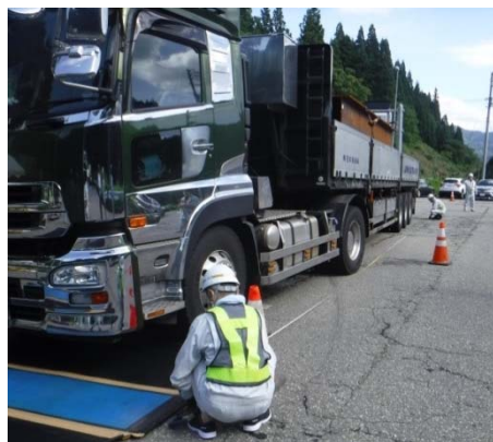
▲車体の高さ、幅、長さの測定
