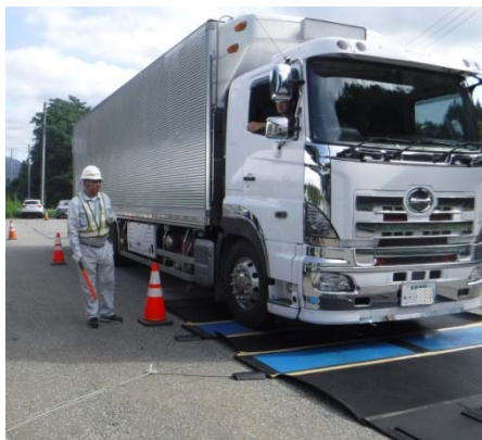
▲マットスケールで車体の総重量を測定
