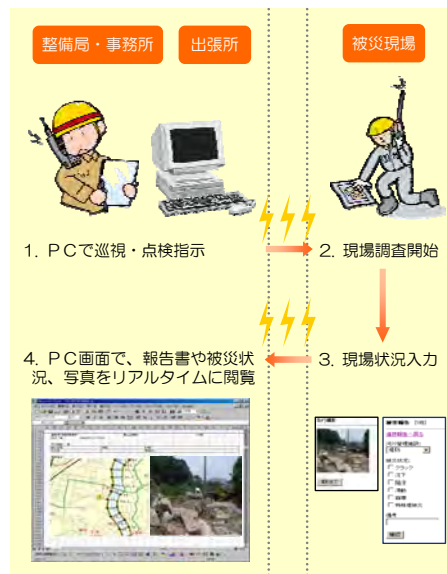
図 5-28 河川巡視点検システムのイメージ
