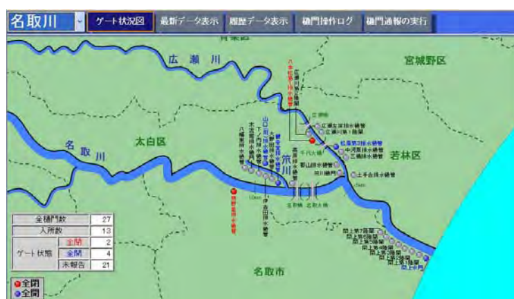
図 5-24 樋門樋管操作システム運用状況
