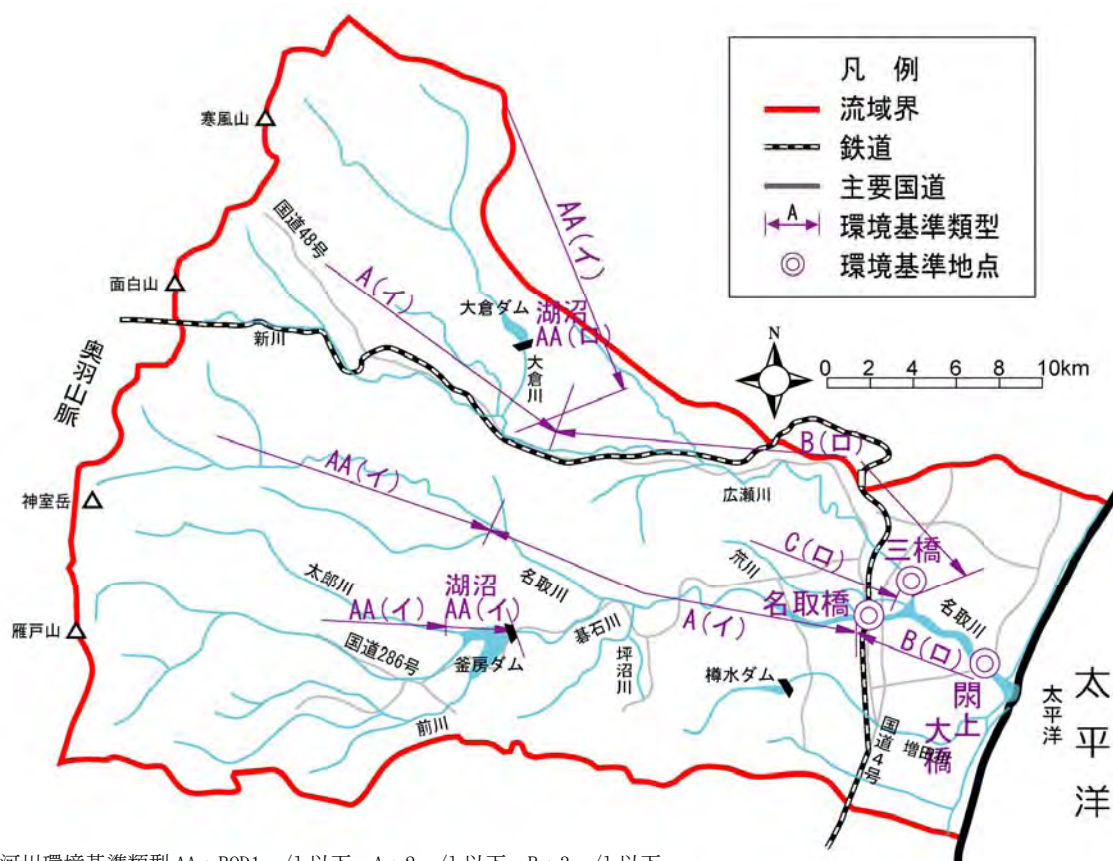
河川環境基準類型 AA：BOD1mg/l 以下、A：2mg/l 以下、B：3mg/l 以下 達成期間 イ：直ちに達成、ロ：5年以内で可及的速やかに達成
