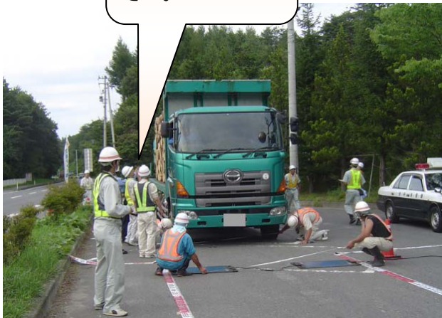
▲車両の幅・長さ・高さ・重さを測定
