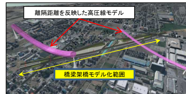
橋梁と架空線の離隔確認
