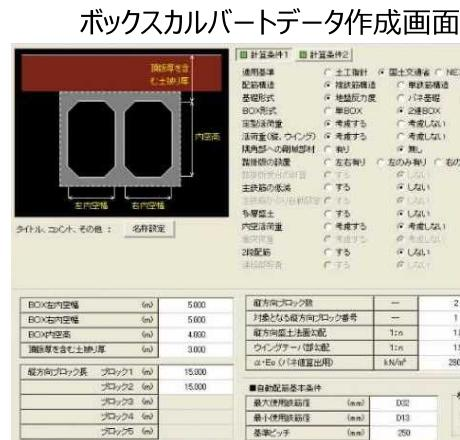
② 「土木構造物標準設計図集」や「土木構造物設計ガイドライン 土木構造物設計マニュアル（案）」等の考え方を基に、各構造物の形状決定に必要なパラメータを設定
