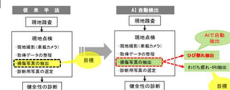
▲舗装点検におけるひび割れ 等のAI自動検出
