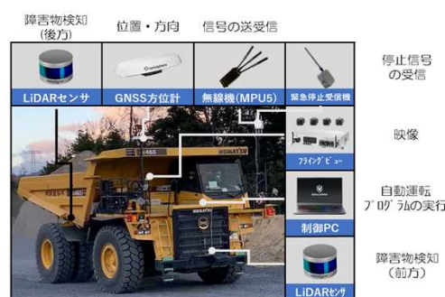
▲リジットダンプの自動化施工
