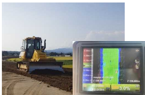
コマツの3DMCブルドーザ(積載盛土制御機能)を活用し3次元設計データ作成等の工数を削減
