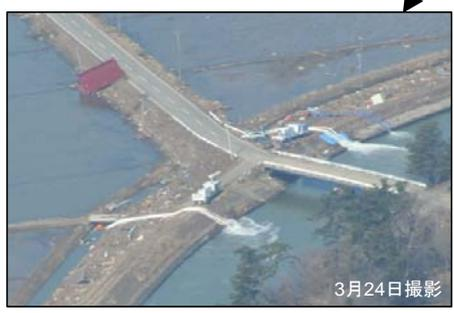
⑤ ポンプ車(30m<sup>3</sup>/min級)稼動状況
