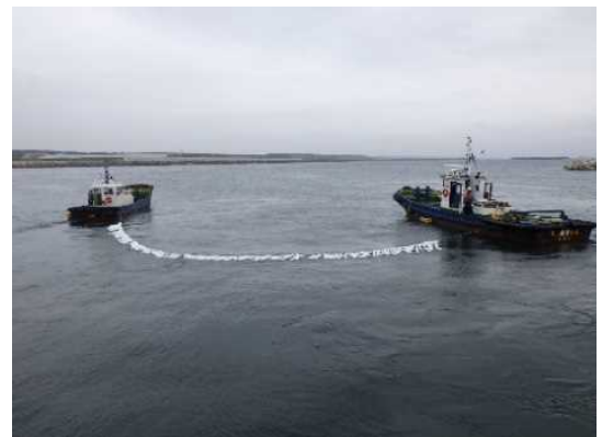
▲埋浚 油吸着材(吹き流し型)による油の回収作業
