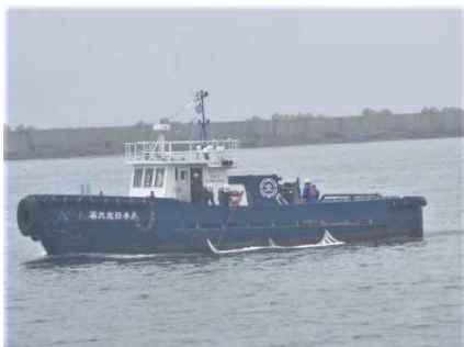
▲埋浚作業船 油吸着材吹き流し型による防除作業状況
