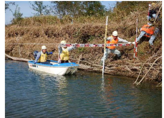
河川護岸等の被害状況を調査(雄物川)
