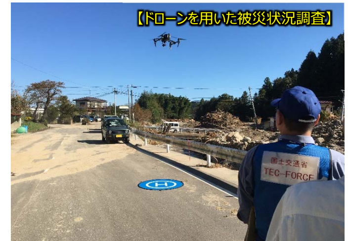
▲ドローンを用いた被災状況調査 (宮城県丸森町)
