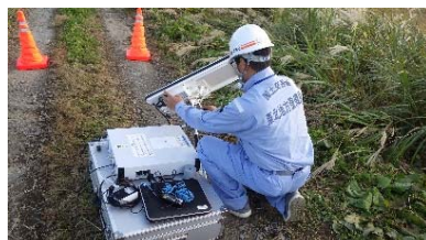
Ku-SATによる映像伝送(鏡石町)
