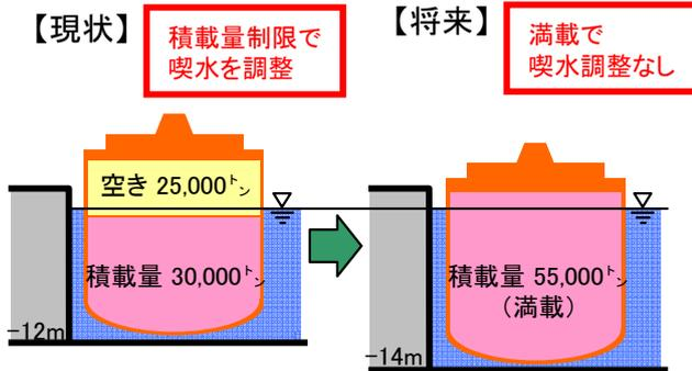
水深14m岸壁の整備により穀物輸送船の満載入港が可能となり、効率的な輸送が実現
