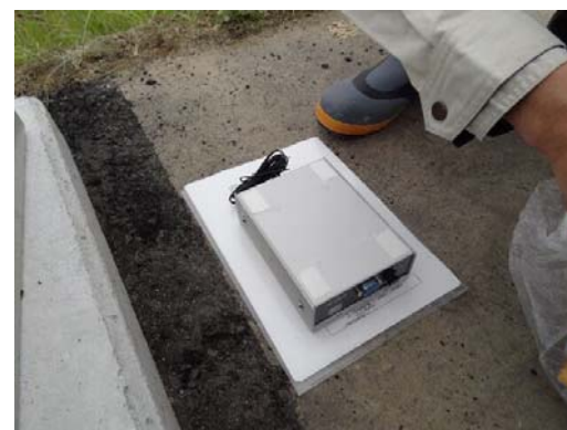
8) 地震計設置(粘着テープ)
