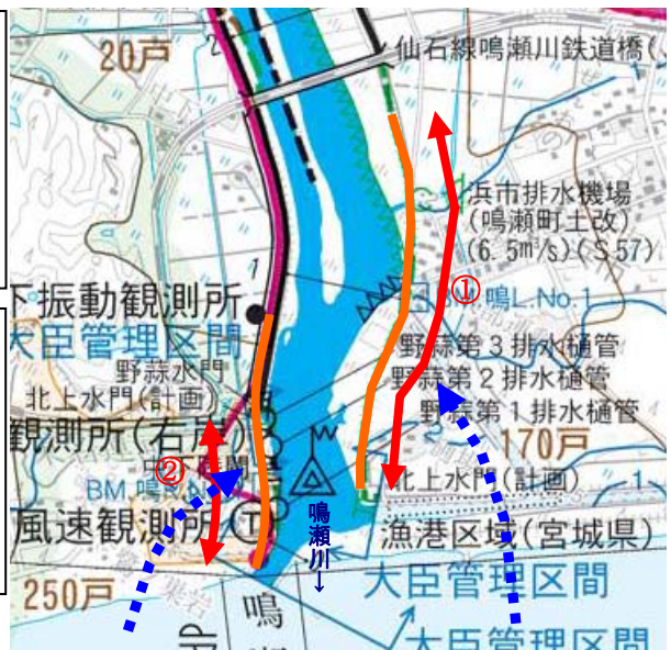
—— 堤防を津波が越水した範囲 (津波痕跡調査より推定) ←--- 津波進入方向(推定)
