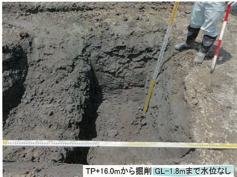
TP+16.0mから掘削 GL-1.8mまで水位なし 川表側トレンチ (T.P. (4.2))
