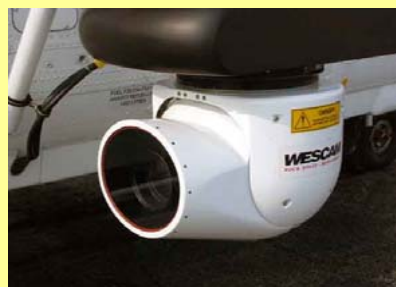
□みちのく号搭載テレビカメラ及び画像伝送装置
