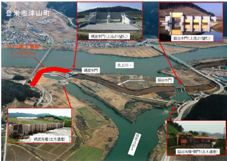
▲洪水時における旧北上川への分派量を0(m 3 /s)にし、沿川約13,000戸の住宅を浸水被害から守ります。
